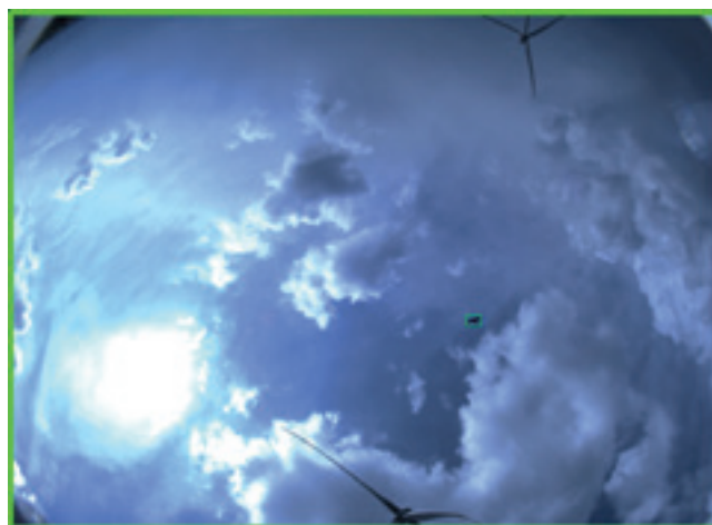
Das Kamerasystem nimmt Vögel auf, die sich der Windkraftanlage nähern und bestimmt deren Abstand anhand ihrer Größe auf dem Live-Bild, Foto: phil-vision
